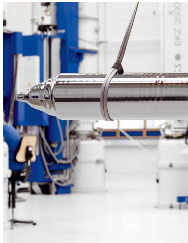
Siliziumstangen verschiedener Größe, fertig zur Weiterverarbeitung
